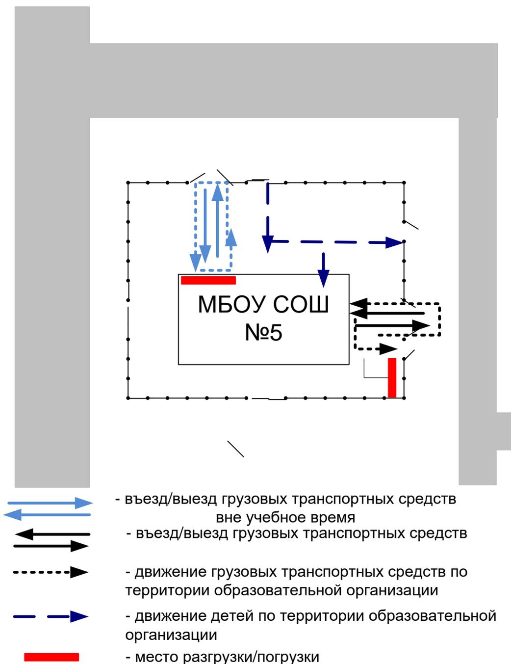
**5. План-схема пути движения транспортных средств и детей при проведении дорожных ремонтно-строительных работ вблизи образовательной организации**
